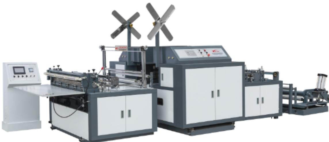
如何选购无纺布制袋机？超声波技术应用于无纺布制袋机利瀚企业，无纺布制袋设备，不同形状的无纺布平口袋、背心袋、穿绳袋、立体袋、插底袋等，设备集机电一体化为一体，运用LCD触摸屏操作，配以步进走料、光电跟踪、电脑自动定位、纠偏、储料、打孔、计数、报警等先进装置，成品封合牢固，切线美观、对边整齐，本机是生产质量无纺布环保袋的理想选择设备。型号:HD-ZD201802 功率20KHZ/1200W 电压220V 重量115kg 外观尺寸1300mm\*650mm\*1500mm 效率: 80-120个/min 规格0-50mm 塑料袋制袋机厂家无纺布制袋机，就选瑞安市鑫达包装机械有限公司，让您满意，期待您的光临！
