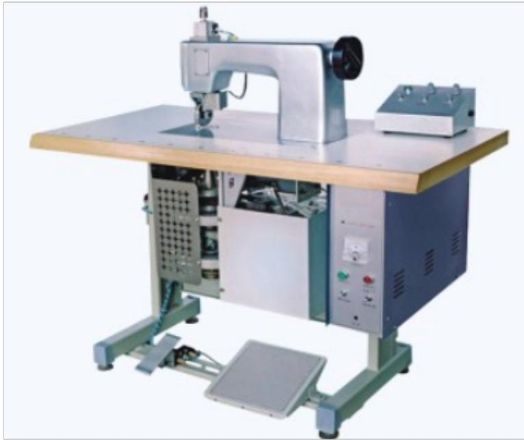
加工范围无纺布制袋机加工范围为各种大小厚薄规格不同的塑料或其他材料的包装袋，一般来说以塑料包装袋为主要产品。当然无纺布制袋机的主要还是纺布为主的产品。不\*是生产无纺布制袋机、还生产各种制袋机。无纺布制袋机超声波粘合技术超声波技术在纺织工业中从初的用于加工床垫和床罩，现在已大规模应用无纺布行业。超声波能量属于机械振动能量，频率超过18000Hz，在人的听力范围之外，扩展阅读：无纺布制袋机、圆织机、四柱液压机、凹版印刷机、开槽机、冷风机有一个普遍的波长范围可供选择。当应用于粘合热塑性材料，如无纺布的粘合，通常使用的频率是20000Hz
